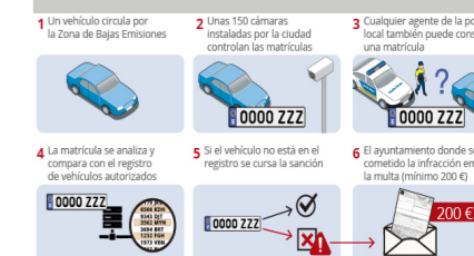
Fig. 5. Funcionamiento del control de vehículos restringidos.
