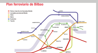
Fig. 8. El nuevo sistema ferroviario propuesto por Bilbao Ría 2000 para reordenar la línea sur.
