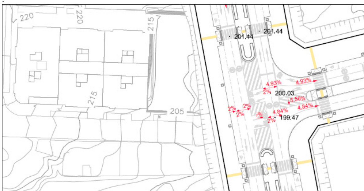
Ilustración 24. Diferencial de cotas en el contacto con el barrio de La Suerte
